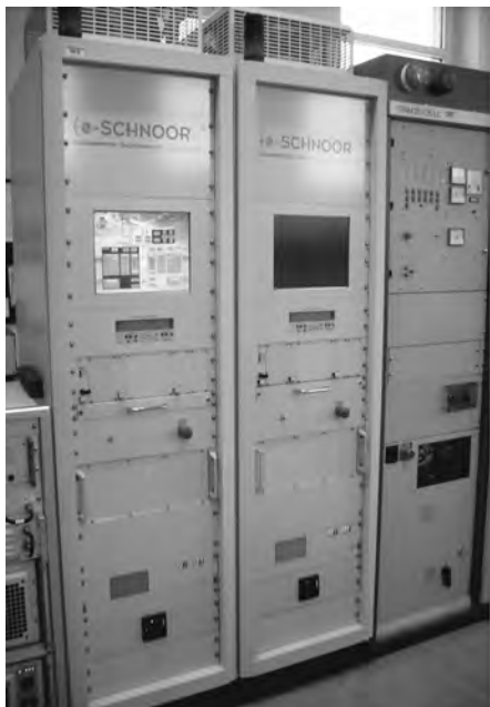
Abbildung 3: NAVTEX-Sender und Langwellensender in der Funkstelle Pinneberg.
